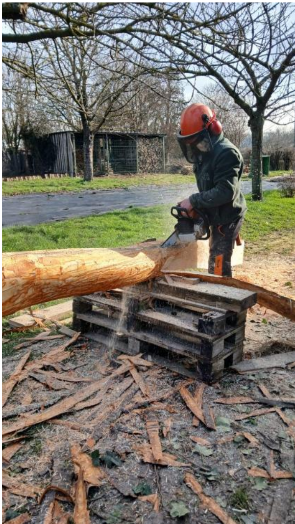
Façonnage d'une grume à la tronçonneuse.
